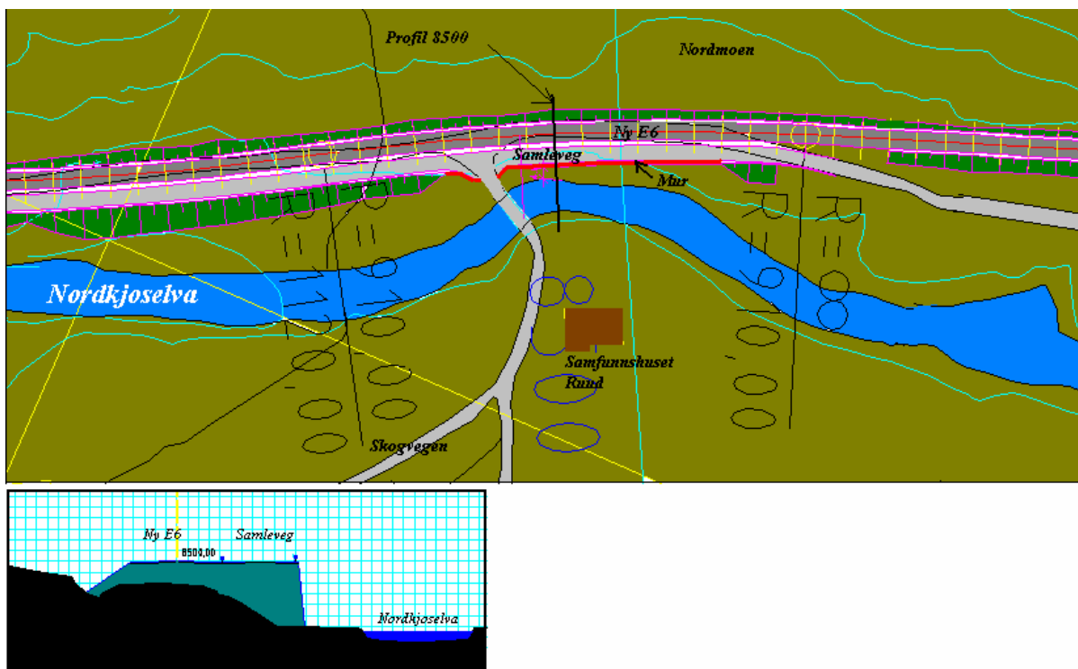
Fig. 2.6.3.7 Avbøtende tiltak alt. 1 v/Nordmoen pr. 8450-8560 - innstramming med inntil 6,0 m høg tørrmur i 110 meters lengde -vist i plan (rød strek) og typisk tverrprofil (pr. 8500).
